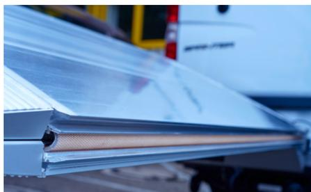
Répartition de la charge est uniforme sur la plateforme grâce à la courroie de charnière.
