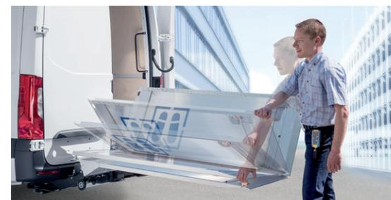
Dans le cas de plus grands volumes, la plateforme s'ouvre hydrauliquement par la commande à distance Bär SmartControl et ensuite, dépliée manuellement.
