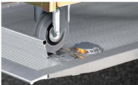
Bloqueur de roll permet le transport simultané de deux rolls conteneurs. Alerter l'entourage de manière fiable : Feux de plateforme LED **CargoFlash**.
