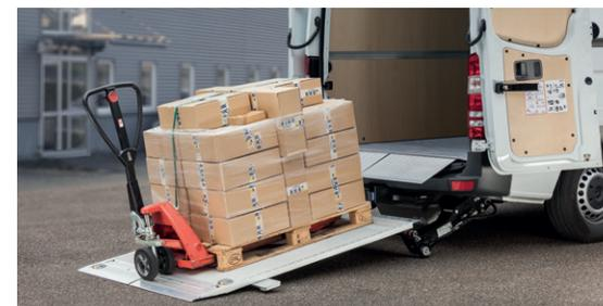
Une fois dépliée, la grande plateforme propose suffisamment de place pour charger et décharger une palette Euro avec un transpalette ou jusqu'à quatre Rolls. Dans le cas d'un transport de palettes réalisé avec un transpalette, la hauteur de la plateforme doit atteindre 71,26" (1810 mm) et un véhicule moteur avec toit rehaussé est indispensable.
