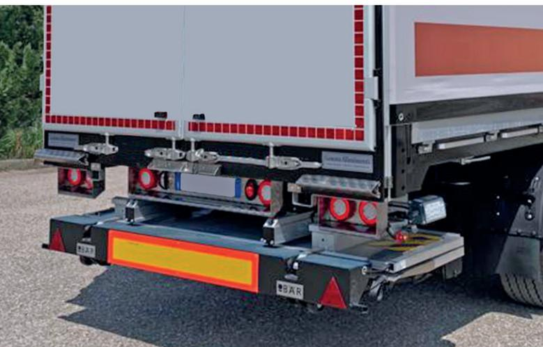
Le Cargolift pour des tâches complexes de logistique : BC 2000 R42. Grâce au pliage en deux fois de la plateforme, ce Cargolift disparaît en position route de façon compacte sous le véhicule moteur. Après une extraction motorisée et assistée par ressort, un dépliage manuel de la plateforme, il est rapidement prêt à entrer en action. Le camion peut donc être librement utilisé en alternance dans la distribution ou le transport à grande distance.
