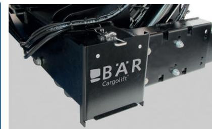
Pour une meilleure protection, le robuste couvercle du tube porteur peut être **cadencé.**
