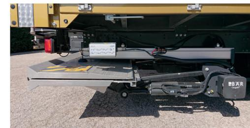
Système de plateforme **BAret45VLL** avec partie fixe et partie mobile en aluminium naturel. Pliage manuel de la plateforme aisé pour l'utilisateur grâce à l'**assistance par ressort**.
